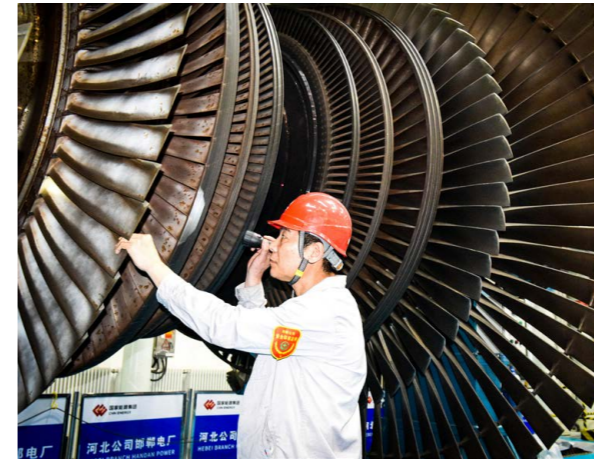
安全管理人员检查汽轮机叶片
